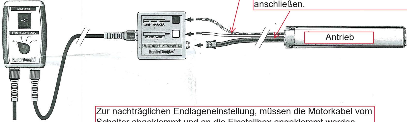
Zur nachträglichen Endlageneinstellung, müssen die Motorkabel vom Schalter abgeklemmt und an die Einstellbox angeklemmt werden. Erst danach können die Endlagen laut Einstellanleitung neu programmiert werden!
